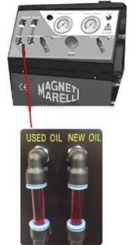
Pri zamjeni ulja, provjerite da nema previše zračnih mjehurića u bilo kojoj cijevi za pregled.
