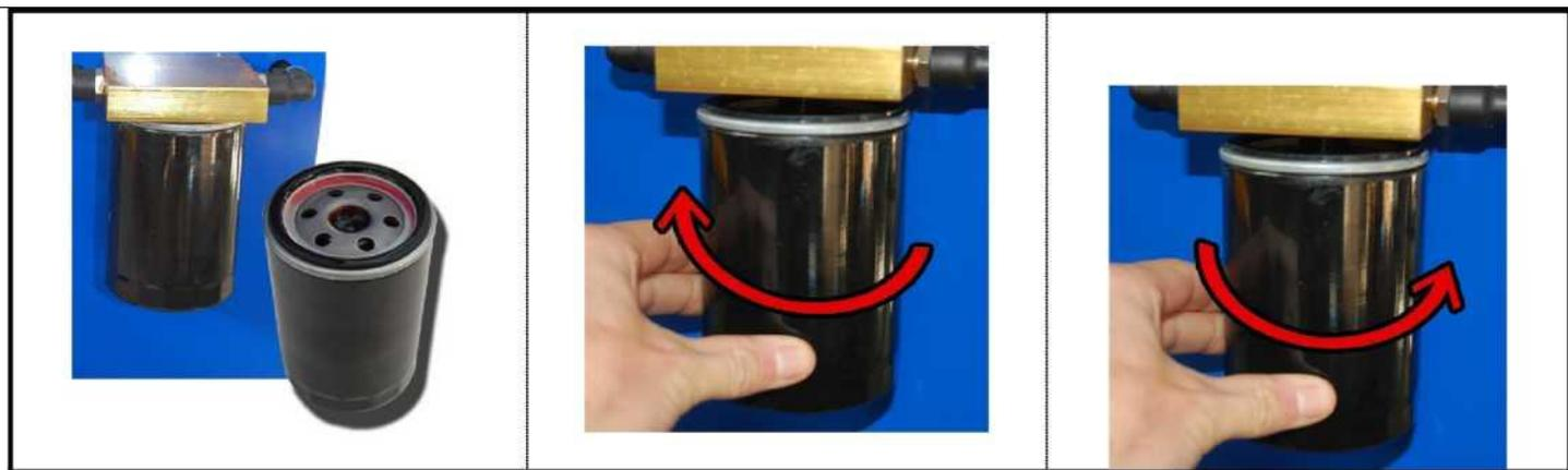
Zamijenite filter kada protok ulja u MM TC-200 postane preslab. **Ne zaboravite prije početka zamjene isključiti uređaj.**
