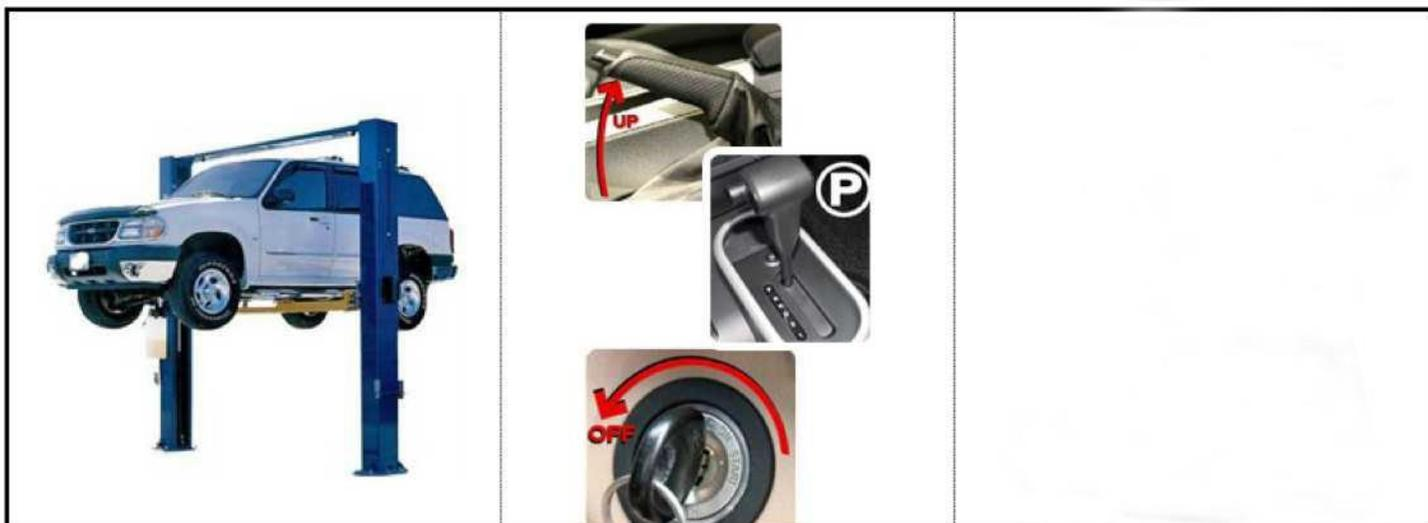
Vozilo dovedite na okvir za dizanje ili na slične sigurnosne nosače u prostoriji s ventilacijom.
