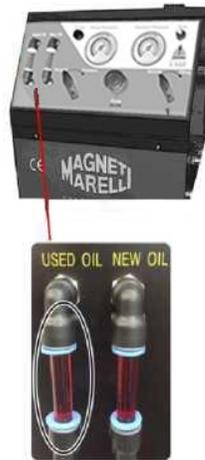
Provjerite protok ulja u inspeksijskoj cijevi.
