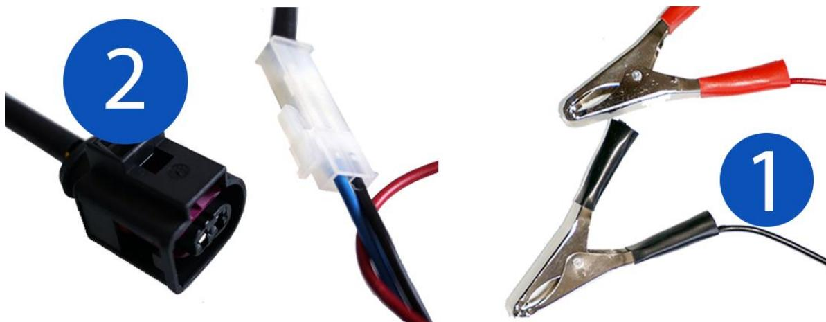
1. Set kablova za napajanje strujom za povezivanje ručnog uređaja s akumulatorom vozila
