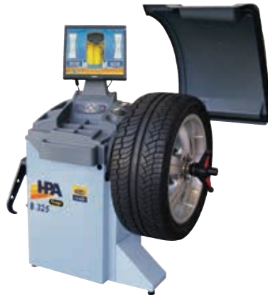
В 325 А – микропроцесорна балансировъчна машина със самокалибриране и самодиагностика, автоматично стартиране, автоматично търсене на позицията, включен предпазен кожух за колело 40 мм Ø 007960001020
