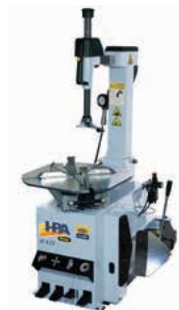
M 420 2V FS 380/3/50 – Автоматична машина за монтиране на джанти с размери от 11" до 20" (външно), стенд с 2 скорости (3 ph – 400 V – 50 Hz), помпа за гуми 007960001330
