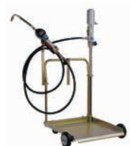
Количка за бъчва 180 – 200 л, с помпа 5:1, електронен пистолет, тръбопровод 4 м 007935016760
