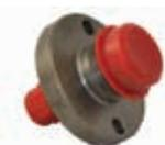
Specijalni alat za obradu ruba ubrizgača
