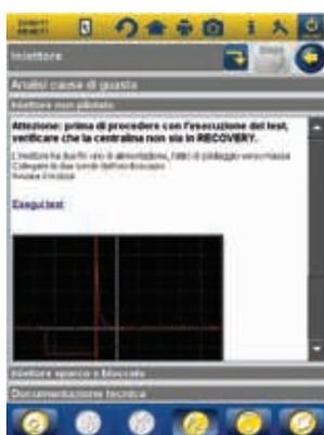
Korisna funkcija koja sadrži standardni osciloskopski valni oblici za odabrane komponente i senzore - dijagnosticiranje s osciloskopom nikada nije bilo tako lako.
