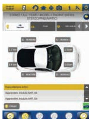
Mogućnost spajanja na TPMS upravljačka jedinica za njegovu konfiguraciju ili dodijeliti nove kodove senzora.
