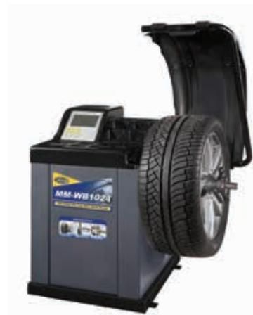
**Uređaj za balansiranje kotača MM-WB1024
